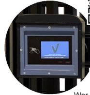
Durch das beidseitige RFID-Zutrittskontrollterminal erhält man ein direktes Signal, ob der Zutritt erteilt oder verwehrt wurde.
