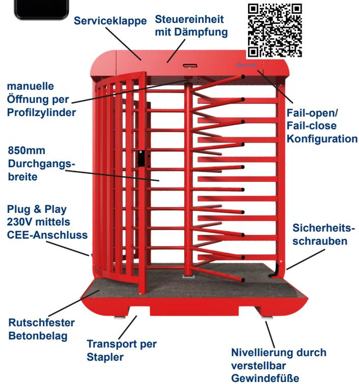
Die Drehkreuze können mit oder ohne RFID-Zutrittskontrolle konfiguriert werden. Zu den Drehkreuzen mit Zutrittskontrolle gehören die einseitige oder beidseitige lokale Zutrittskontrolle sowie eine beidseitige RFID-Zutrittskontrolle mit Terminal.
